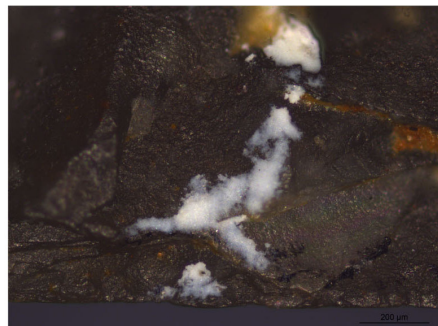
Afb. 19.6 A: Wit (krijt) residu op V10463. B: Sporen van contact met metaal op V17876.
